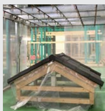
ヴェルウッドを設置した状態で散水試験を実施。
