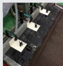
ヴェルウッドを設置した状態で流水試験を実施。 (取付ビスの止水性評価)
